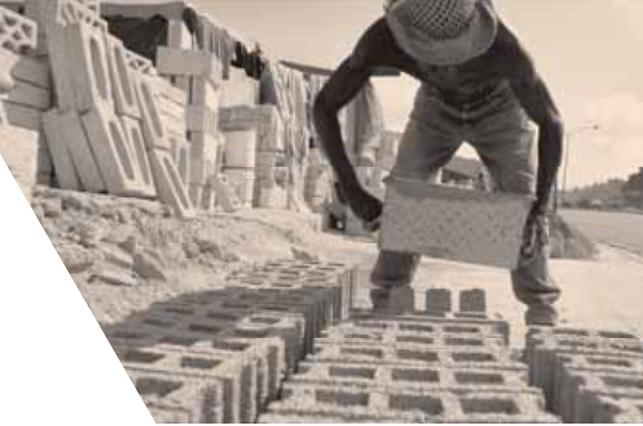
Gauche : Fabrication à la main de blocs de ciment à Port-au-Prince (Haïti).
