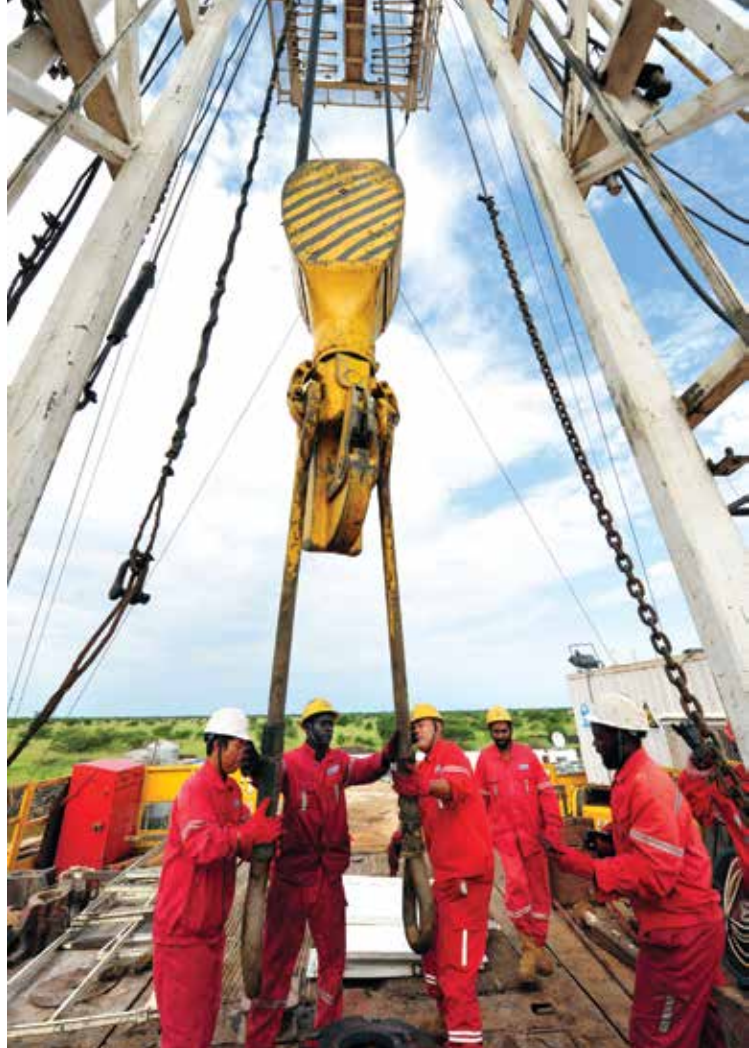
Travailleurs chinois du Bureau d'exploration pétrolière de Zhongyuan (ZPEB) de Sinopec et travailleurs soudanais forant un puits au Soudan du Sud.
