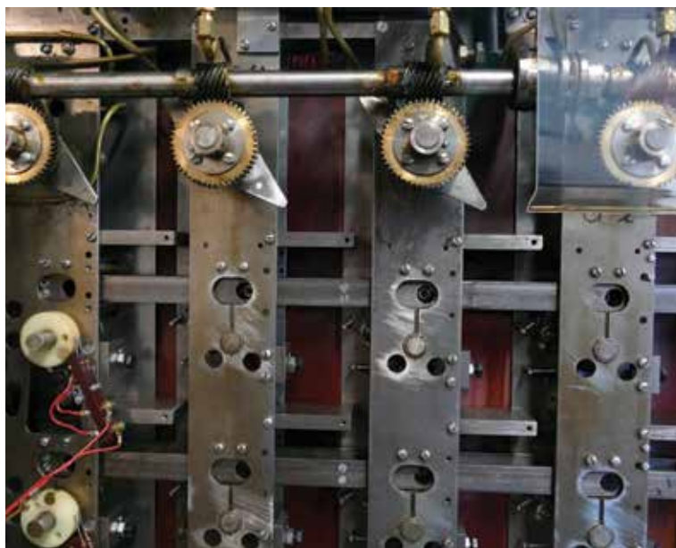
Detalle de un dispositivo “Bombe” reconstruido, una máquina electromecánica descifrador de códigos utilizada por criptólogos británicos durante la Segunda Guerra Mundial. Turing desempeñó un papel decisivo en el desarrollo de esta máquina, adaptada de un diseño polaco.
